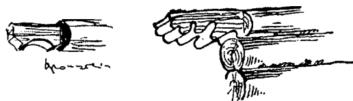
Рис. 45. Кронштейны («выпуски») кровель севернорусских домов
